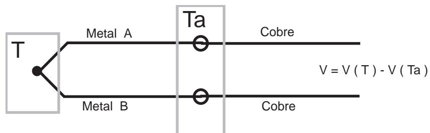
Antiguamente se solucionaba este problema colocando los empalmes en un baño de hielo a cero grados para que generen cero voltaje ( $T_a = 0$  y luego  $V(T_a) = 0$  ).
