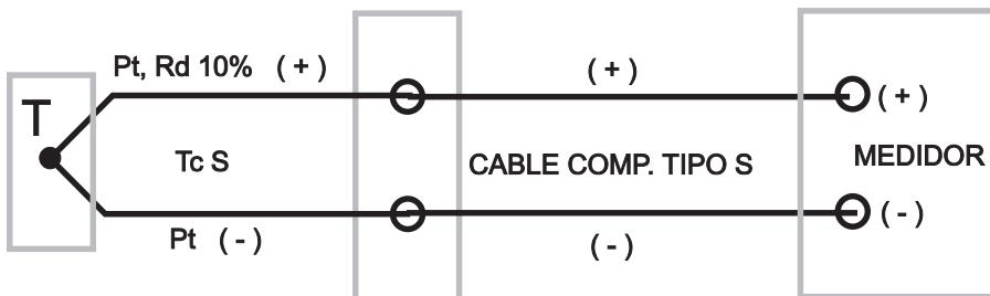
Los cables compensados tienen una polaridad de conexión (+) y (-) que al conectarse con la termocupla se debe respetar.
