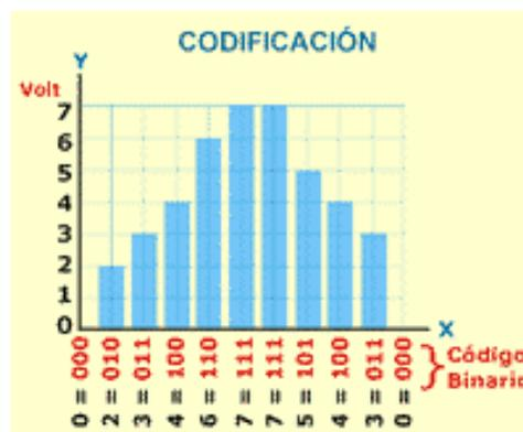
Figura 5. Codificación binaria y decimal equivalentes a los valores de tensiones que conforman la señal eléctrica analógica original.
