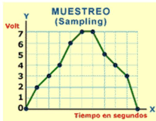
Figura 2. Señal analógica muestreada
